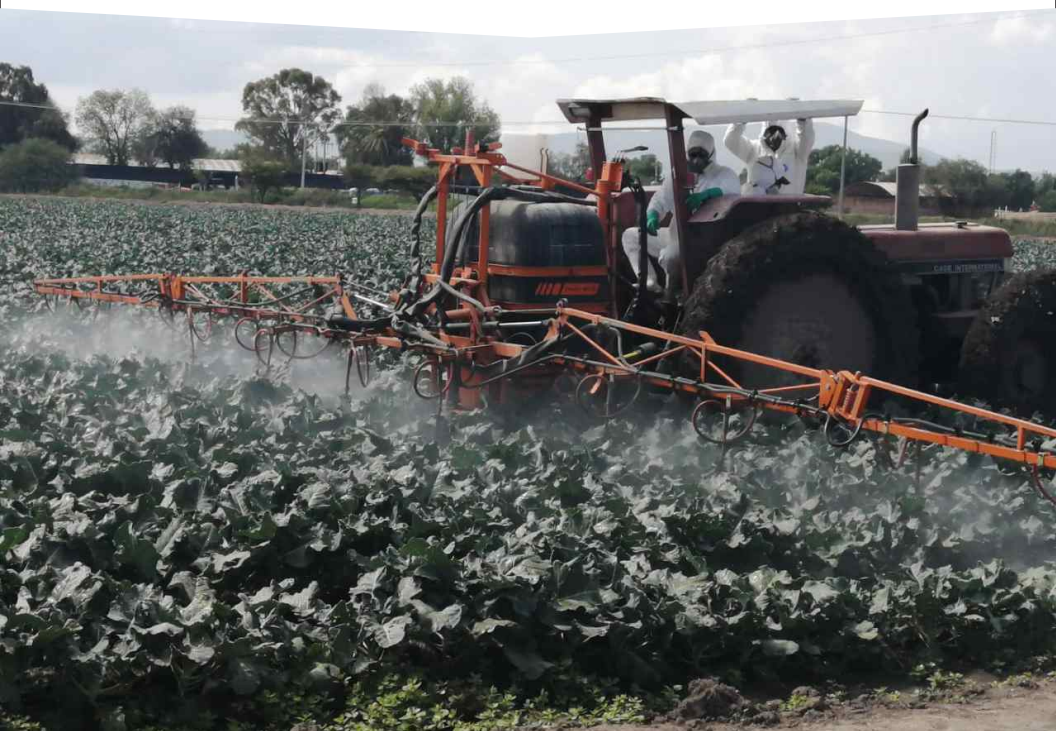
Figura 26. Calibración del equipo de aspersión montado al tractor.
