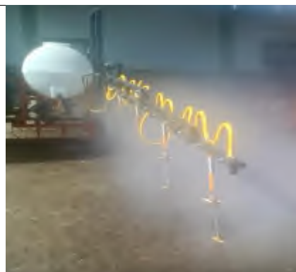
Figura 35) Aguilón con extensiones laterales
